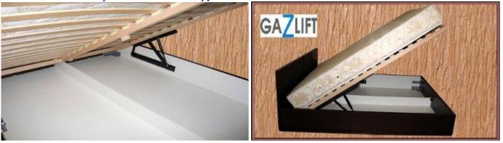
Поставляемые нашей фирмой механизмы трансформации комплектуется газовой пружиной усилием 650N - 2000N, производства немецкой компании "SUSPA", предназначенных для подъема спального места в коробе. Данный механизм трансформации позволяет поднимать спальное место на угол до 36 градусов. Наличие газовой пружины обеспечивает плавную и бесшумную работу, увеличивает долговечность и повышает потребительские свойства данного изделия.
