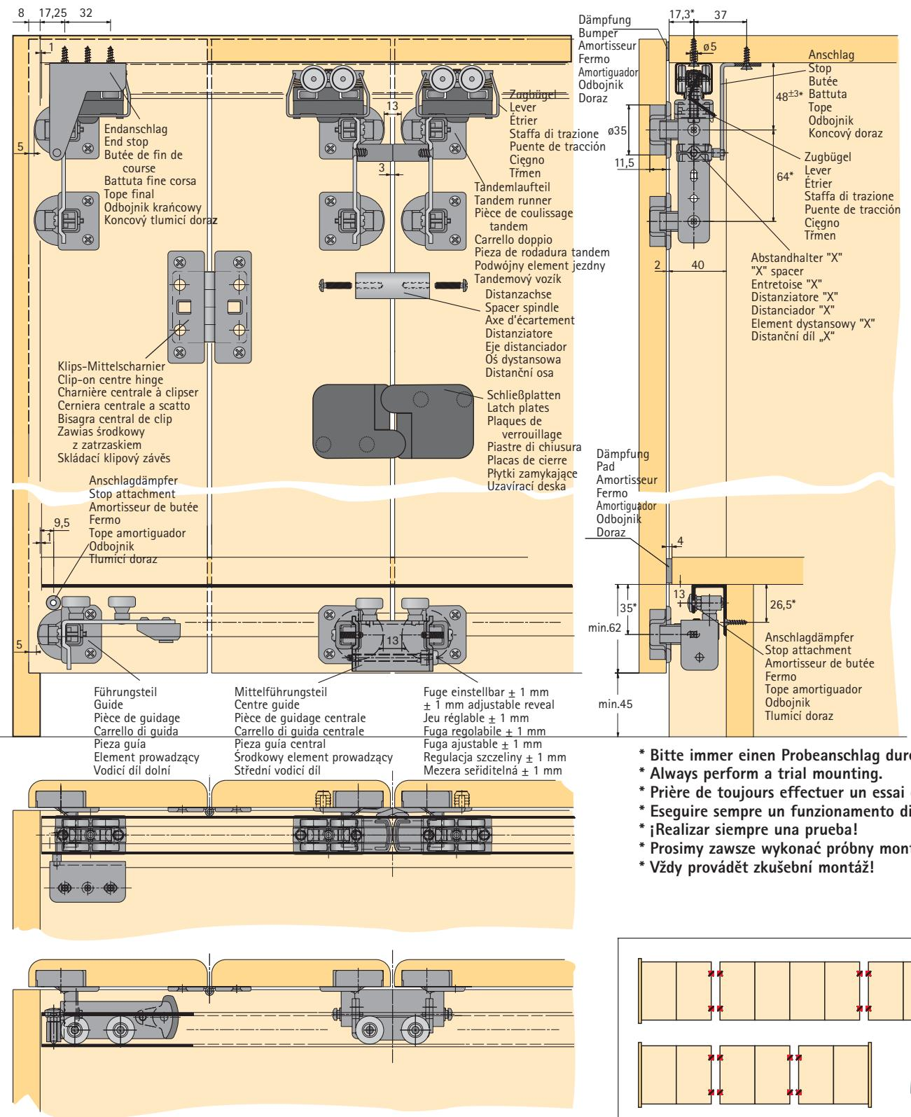
**D** Türkombinationen Durch die Montage von Abstandhaltern "X" (Fuge nicht einstellbar) an die Lauf- und Führungsteile sind Türkombinationen auf durchgehenden Lauf- und Führungsprofilen möglich.
